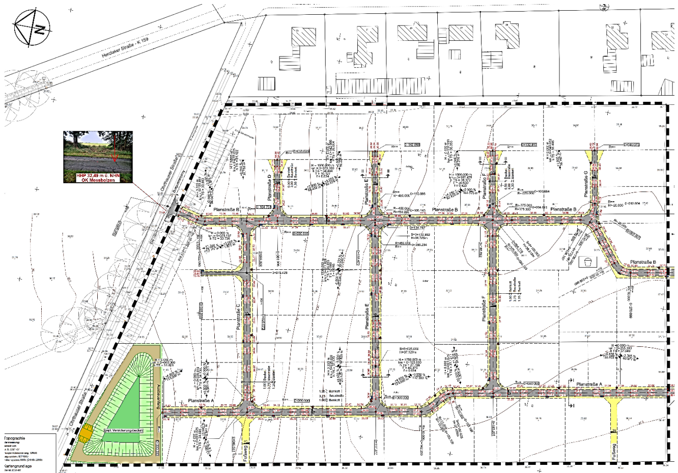
Abb. Lageplan Baustraße, Ausführungsplanung Erschließung (Quelle: Ingenieure + Planer)
